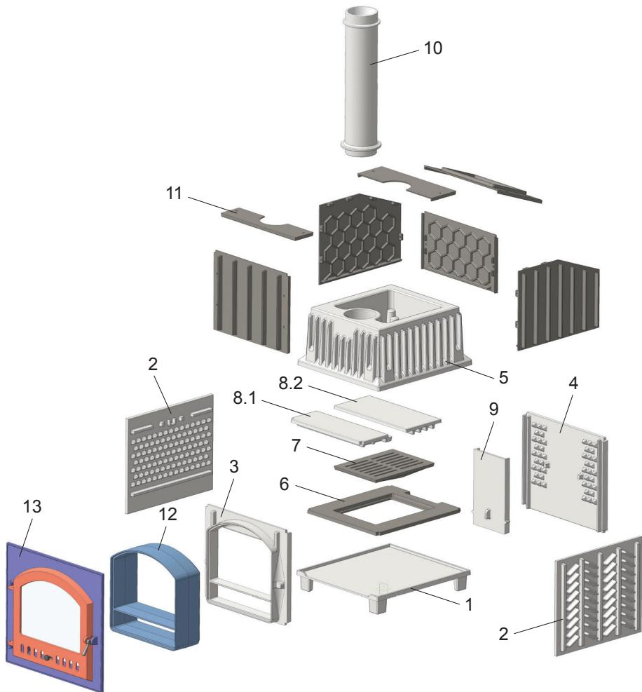
1 – основание; 2 – стенка боковая (2 шт.); 3 – стенка передняя; 4 – стенка задняя; 5 – каменка; 6 – рамка колосниковая; 7 – решетка колосниковая; 8.1 – плавегаситель №1; 8.2\* – плавегаситель №2; 9 – воздушник; 10 – труба стартовая; 11 – короб каменки в сборе; 12 – удлинитель портала; 13 – портал с дверцей в сборе.
