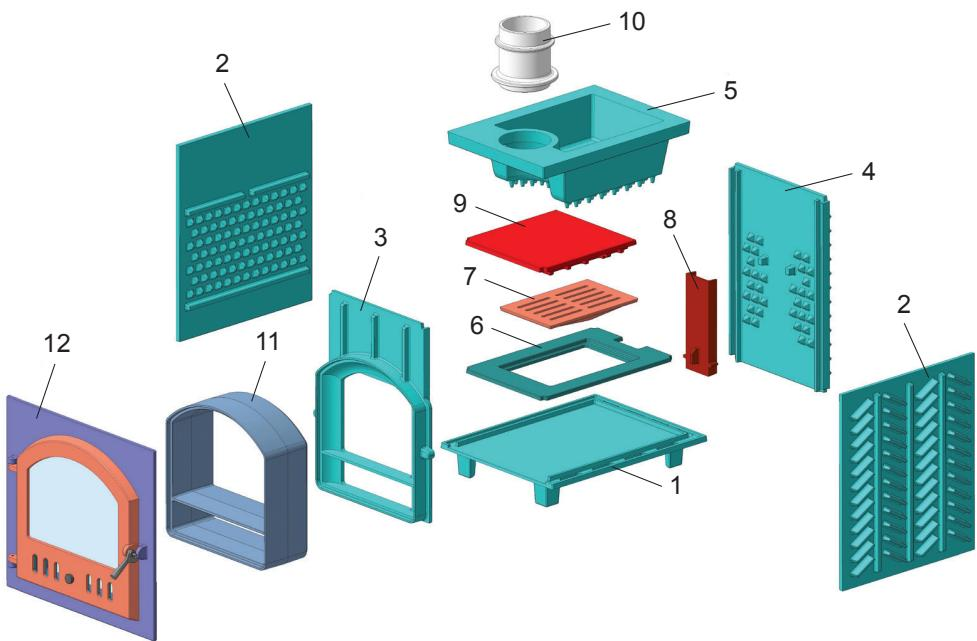
1 – основание; 2 – стенка боковая (2 шт.); 3 – стенка передняя; 4 – стенка задняя; 5 – каменка; 6 – рамка колосниковая; 7 – решетка колосниковая; 8 – воздушник; 9 – пламегаситель; 10 – труба стартовая; 11 – удлинитель портала; 12 – портал с дверцей в сборе.
