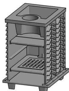
г) Нанесите герметик в пазы передней стенки. Установите переднюю стенку нижней кромкой на основание печи, приподнимите передний край каменки, плотно прижмите переднюю стеку к кромкам боковых стенок и опустите каменку.
