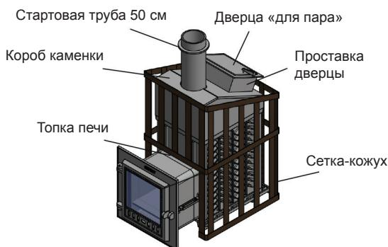
а) Собирите топку печи по инструкции выше, не устанавливая стартовую трубу 500 мм. Установите короб для камней на каменку. Герметик при сборке и установке короба наносить не нужно.
