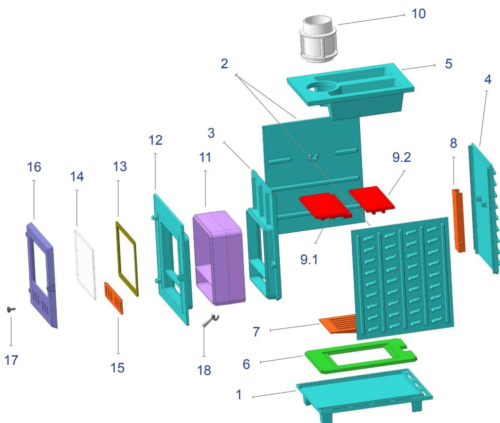
1 –основание; 2 –стенка боковая (2 шт.); 3 –стенка передняя; 4 –стенка задняя; 5 –каменка; 6 –рамка колосниковая; 7 –решетка колосниковая; 8 - воздушник ; 9.1 –пламегаситель №1; 9.2 –пламегаситель №2; 10 –труба стартовая; 11 –удлинитель портала; 12 –портал; 13 –прижимная рамка; 14 –стекло огнеупорное; 15 –задвижка; 16 –дверка (с кремнеземным шнуром-уплотнителем Ø 6 мм); 17 - рукоятка; 18 –защелка-крючок
